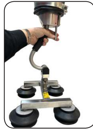
Enhåndsbetjent vakuumsugehoved Model UNO 90° Rustfri - Meget præcis håndtering - Blødere arbejdsgang for operatøren - Mindre støj
